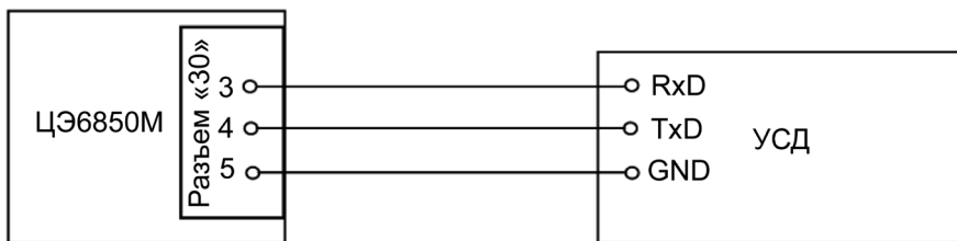
Рисунок 4.6 – Схема подключения интерфейсных линий EIA232
