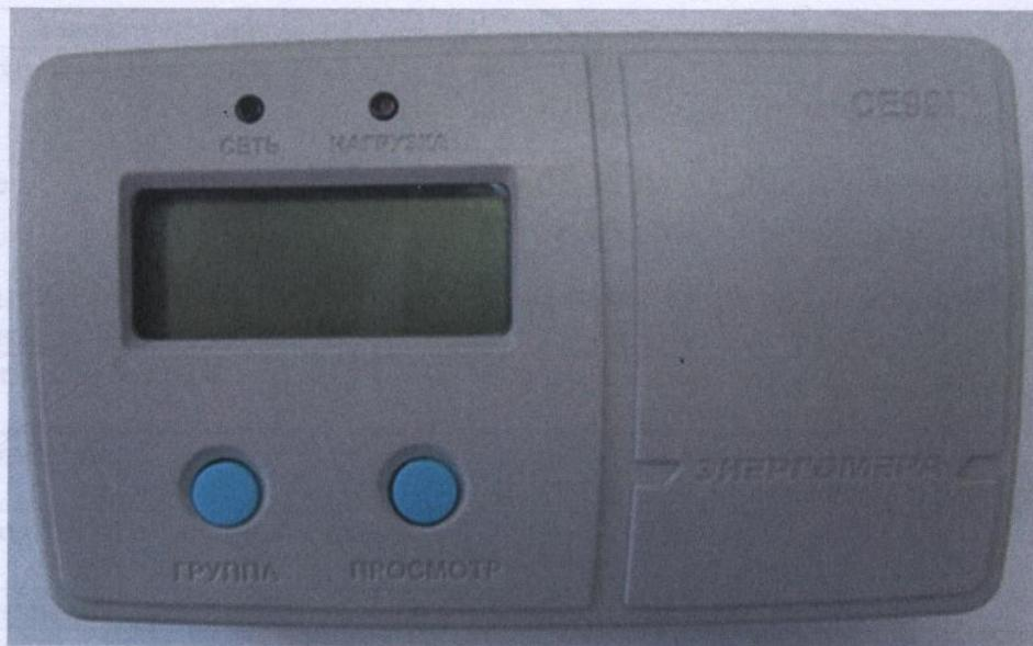
Рисунок 10 - Общий вид устройства считывания счетчиков СЕ901
