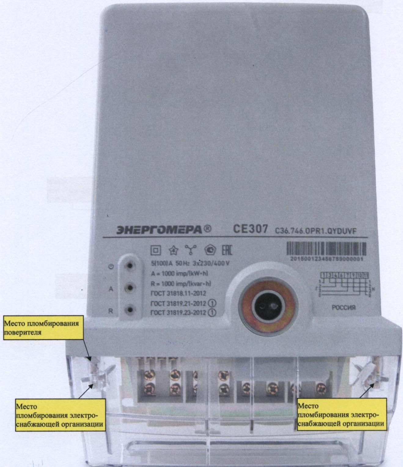
Рисунок 7 - Общий вид счетчика СЕ307 С36
