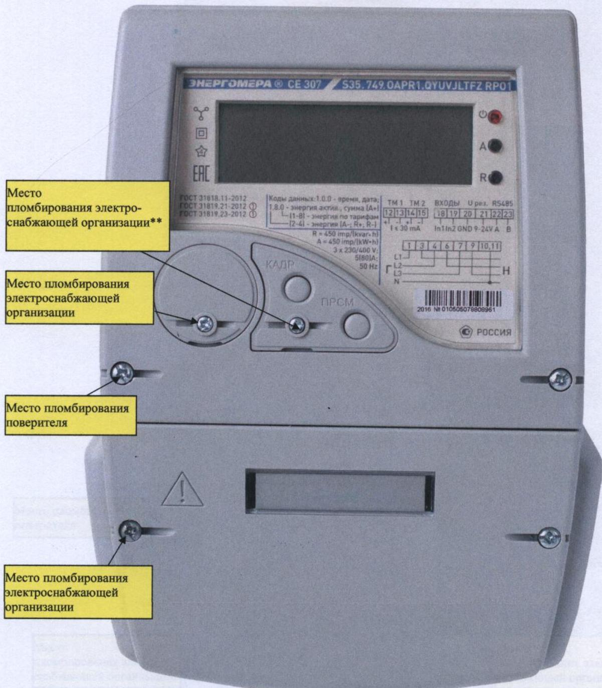
Рисунок 6 - Общий вид счетчика СЕ307 S35\*
