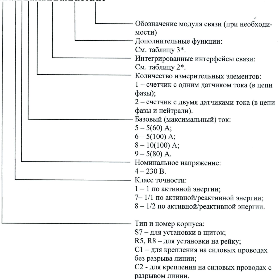
Рисунок 1 - Структура условного обозначения счетчиков
